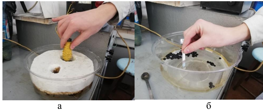
Рис. 1. Эксперимент: а – погружение электромагнита; б – результат, после работы магнитного нефтесорбента
