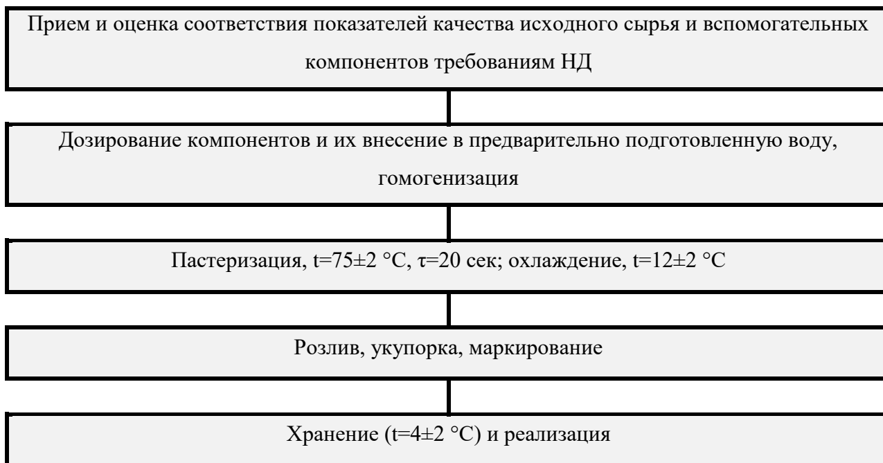
Рисунок 8.2.3 – Процессуальная схема производства концентрата – основы морсов иммуномодулирующего действия
